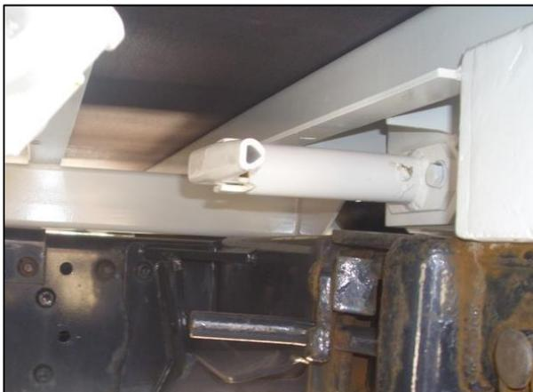
8.) Wenn alle Stützbeine in senkrechter Stellung verriegelt sind, Fahrzeug mittels Luftfederung ablassen. Dabei darauf achten, dass alle Twistlocks nach unten ausgehängen sind.
